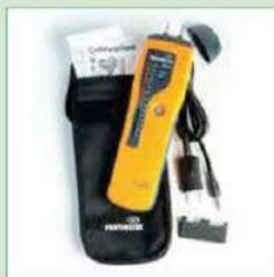
ACCESSOIRES POUR INDICATEUR D'HUMIDITÉ «PROTIMETER MINI»
