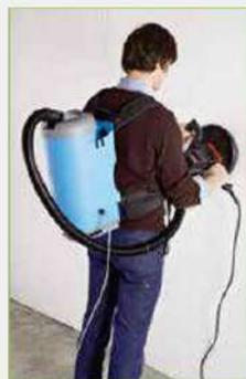
Peut se connecter à la ponceuse basse vitesse «PBV 225» pour les plaques polystyrène d'I.T.E.
