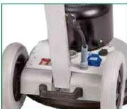
Divers branchement : électrique / Aspiration / sortie USB
