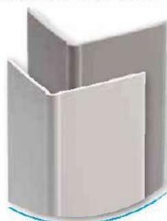
Cornière à angle variable avec liseré flexible qui lui permet de se conformer à tous les types d'angles rentrants ou sortants. En PVC lisse, antibactérien, classé Bs2 d0. Épaisseur 2 mm. Adhésif mousse
