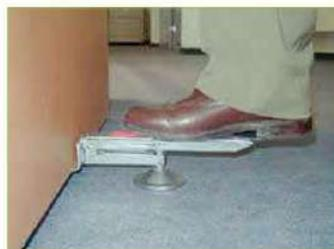
Pour tout montage, démontage, installation de portes, fenêtres, meubles, parois, cloisons... La surface où repose le pied a un revêtement de caoutchouc. En conséquence, il n'y a aucun risque de déraper.
