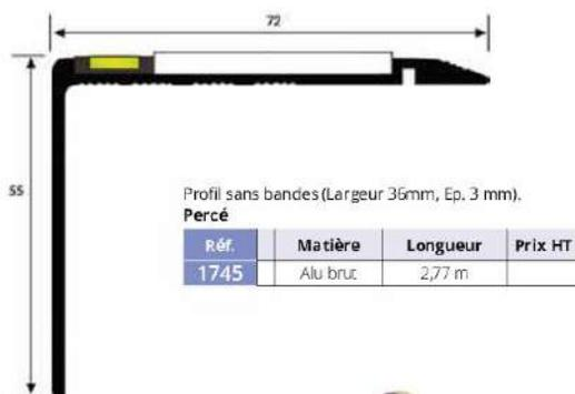
Résultat test lumineuse si exposition à 150 lux pendant 15 minutes. Durée maxi de visibilité: 5h15.
