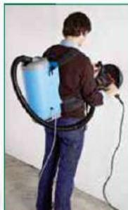
Peut se connecter à la ponçuse basse vitesse «PBV 225» pour les plaques polystyrène d'I.T.E.
