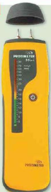
**Principe :** Très performant. Plonger les pointes dans le matériau. La diode en couleur indique instantanément sur l'échelle graduée les possibilités de pose.
