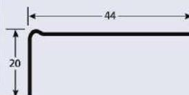
Pour réparer les nez de marches usagés, en bois ou béton. À clouer ou à visser, avant de refaire le ragréage par dessus. Tôle galvanisée.
