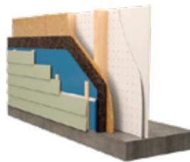
**Murs Extérieurs** Remplissage de murs extérieurs en structure de bois avec des granulés
