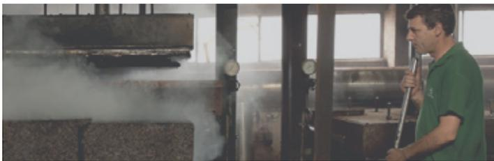
Une fois placé dans un autoclave et exposé à la vapeur surchauffée à 350 ° C (662 ° F) les granules de liège se dilatent et libèrent leur propre résine (subérine), un liant naturel à l'intérieur du liège. Aucun liant ou produit chimique est ajouté, puisque le liège est aggloméré en blocs avec sa propre résine.
