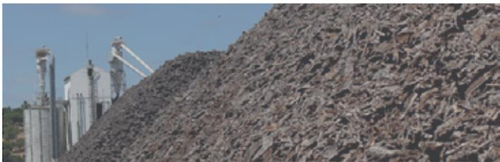
L'aggloméré de liège expansé est produit à partir de la «falca», un type de liège unique qui est collecté périodiquement à partir des branches supérieures du chêne-liège. Une fois extrait, la « falca » est stocké dans la cour de l'usine.
