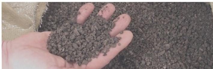
**Granulé de liège expansé.** Solution de remplissage léger ayant des propriétés d'isolation acoustique pour l'application dans les planchers, sols et doubles parois intérieures.
