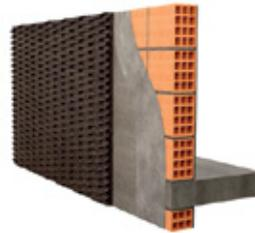
**Murs Extérieurs** Revêtement extérieur sur isolation - liège visible
