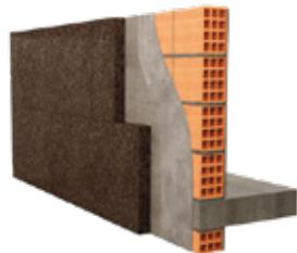
**Murs Extérieurs** Revêtement extérieur visible avec système de fixation mécanique
