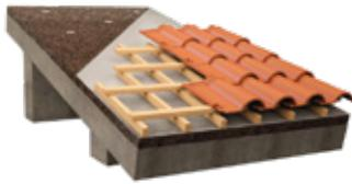
**Toitures** Toiture inclinée avec isolation sur dalle horizontale
