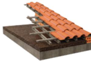
**Toitures** Remplissage des compartiments sur dalle horizontale
