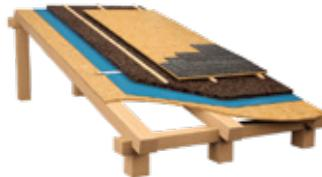
**Toitures** Toiture plate avec isolation en pente
