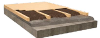
**Applications Dalles et Revêtement de Sols** Mortier de remplissage (béton léger)
