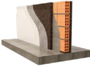
**Murs Intérieurs** Double paroi avec isolation remplissant totalement le vide
