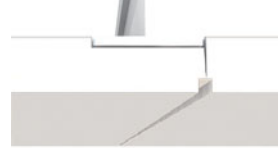
Bord D+ (Contur) T24 ossature cachée démontable Dimensions standard (mm) 600 x 600 x 12,5 mm
