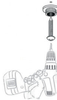
3. L'embout déco plafond est constitué de 2 parties : la première se fixe au support. Choisir le type de vis en fonction du support.
